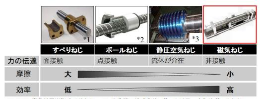
\*1: NTN, 高負荷用樹脂すべりねじ \*2: 東北精工株式会社, ボールリテーナ入りボールねじ \*3:TOSHIBA MACHINE, 静圧ウォームラック送り機構
