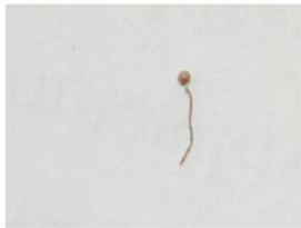
f=4 L/min, P_{in}=30 W \phi 0.11 mmの銅線
