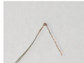
f=2 L/min, P_{in}=40 W \phi 0.11 mm銅線の溶接
