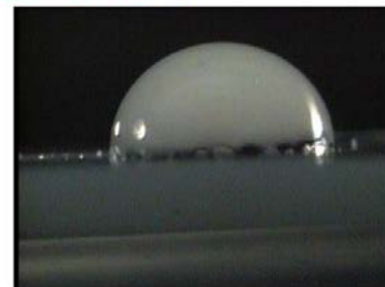
液滴落下時の現象 (写真は撥水性材料)
